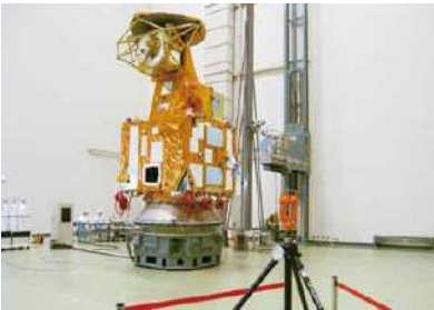
アライメント測定設備(@SITE)
