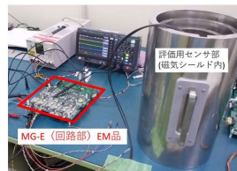
図8 MMX向け新方式磁力計センサ部(MG-S) (左)及び、性能試験中の回路部(MG-E) (右)。いずれもEM品。
