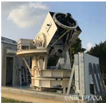
NICT沖縄電磁波技術センター 内の光地上局に設置されている 1m光学望遠鏡
