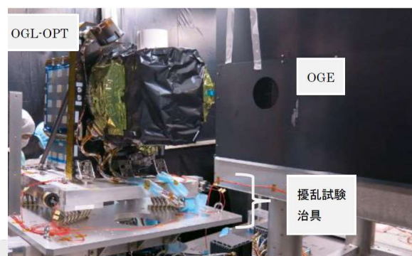
OGL-OPT (EM)擾乱伝達特性試験セットアップ (資料提供NEC(本図の転載禁止))
