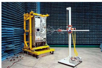
電磁適合性試験設備(@衛星試験棟)
