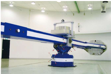
旋回腕型加速度試験設備(@構造試験棟)
