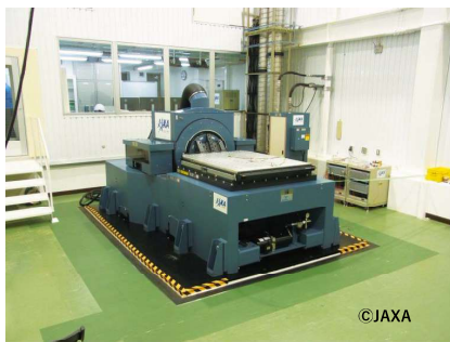
JAXA小型振動試験設備(SRS設定の衝撃試験が可能)と100GSRS目標での制御結果
