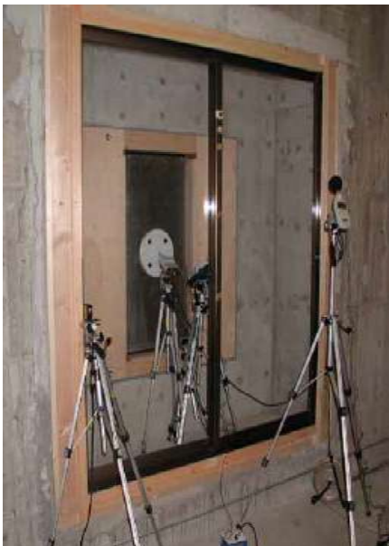
建具のがたつき試験装置
