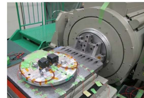
図9 MG-S EM品2式の振動試験の様子。
